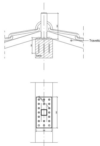
Ancoraggio puntuale TIPO A fissaggio a cantonale
